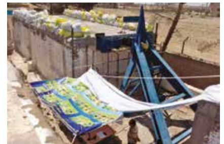
نمایی از بالای ساختمان مورد آزمایش به همراه قاب بارگذاری و وزن اضافه شده روی بام
