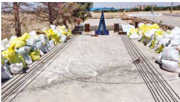
نمایی از پشت‌بام به همراه استرندهای تنیدگی برای اعمال بارگذاری رفت و برگشتی و کیسه‌های خاک برای تامین کمبود وزن
